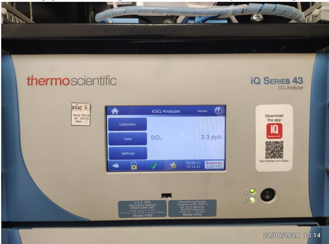
*Equipo analizador de gas SO<sub>2</sub> marca Thermo Scientific, modelo 43i*
