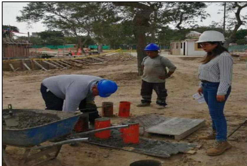
**ANEXO D: REALIZACIÓN DE PROBETAS CON RESIDUOS DE PORCELANA
