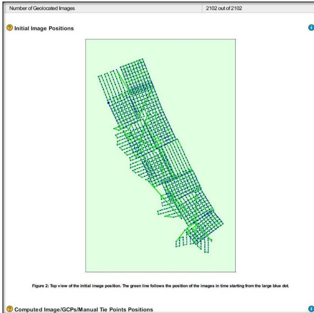
*Nota.* Este reporte nos sirve para visualizar el Desplazamiento entre las posiciones de la imagen inicial (puntos azules) y calculada (puntos verdes), así como el desplazamiento entre las posiciones iniciales de los GCP (cruces azules) y sus posiciones calculadas (cruces verdes) en la vista superior (plano XY), vista frontal (plano XZ) y vista lateral (plano YZ)
