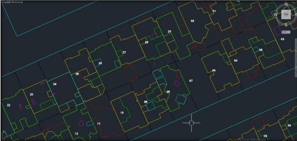
Después del proceso de restitución en el software Autocad civil, se procedió a trabajar en el software Pix4D, con la nube de puntos para identificar los niveles de edificación. La nube de puntos 3D es el conjunto de puntos de una superficie, posicionados en tres dimensiones X, Y, Z, formando con exactitud una entidad física y representando una superficie externa.
