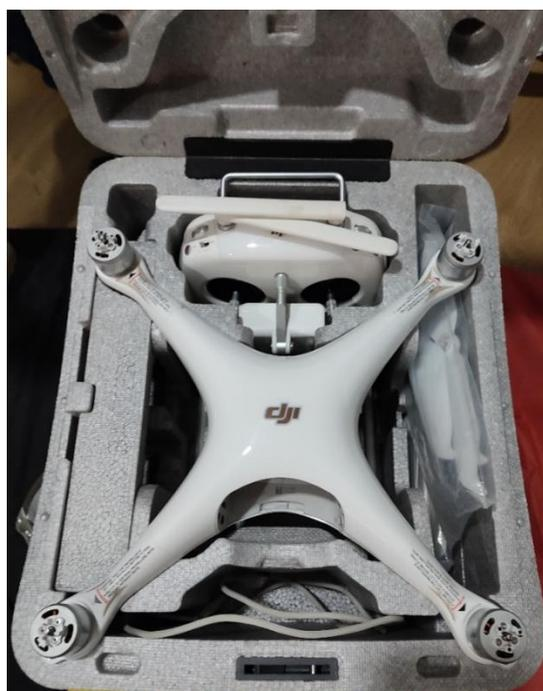
*Nota.* Equipo RPAS marca DJI y modelo Phantom 4 Pro V2, equipo multirotor, mando, juego de hélices, memoria micro SD, cables, y maletín de transporte.
