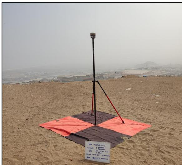
*Nota.* Se observan los accesorios a utilizar como bastón de fibra de carbono de 2 m, bípode de apoyo, marca terrestre fotoidentificables de 2 x 2 m y pizarra acrílica.
