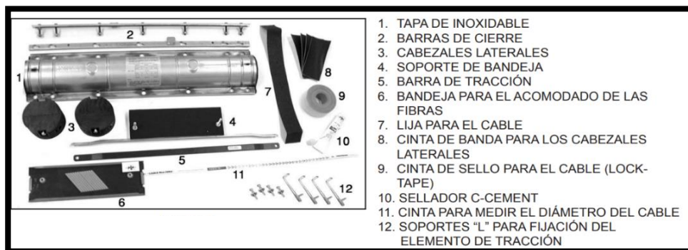
Figura N°05: Caja de Empalme de fibra óptica OPGW
