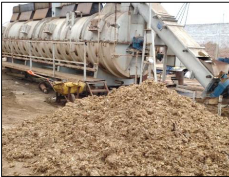
c) Descarga de digestor
