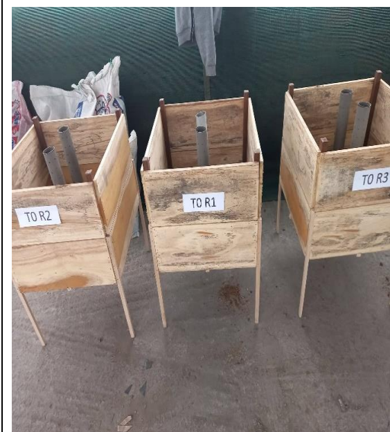
Acondicionamiento interno del las dispositivos de almacenamiento de madera - Sistema de aireación y/o drenaje
