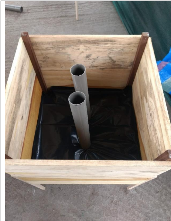
Acondicionamiento interno del las bandejas de madera
