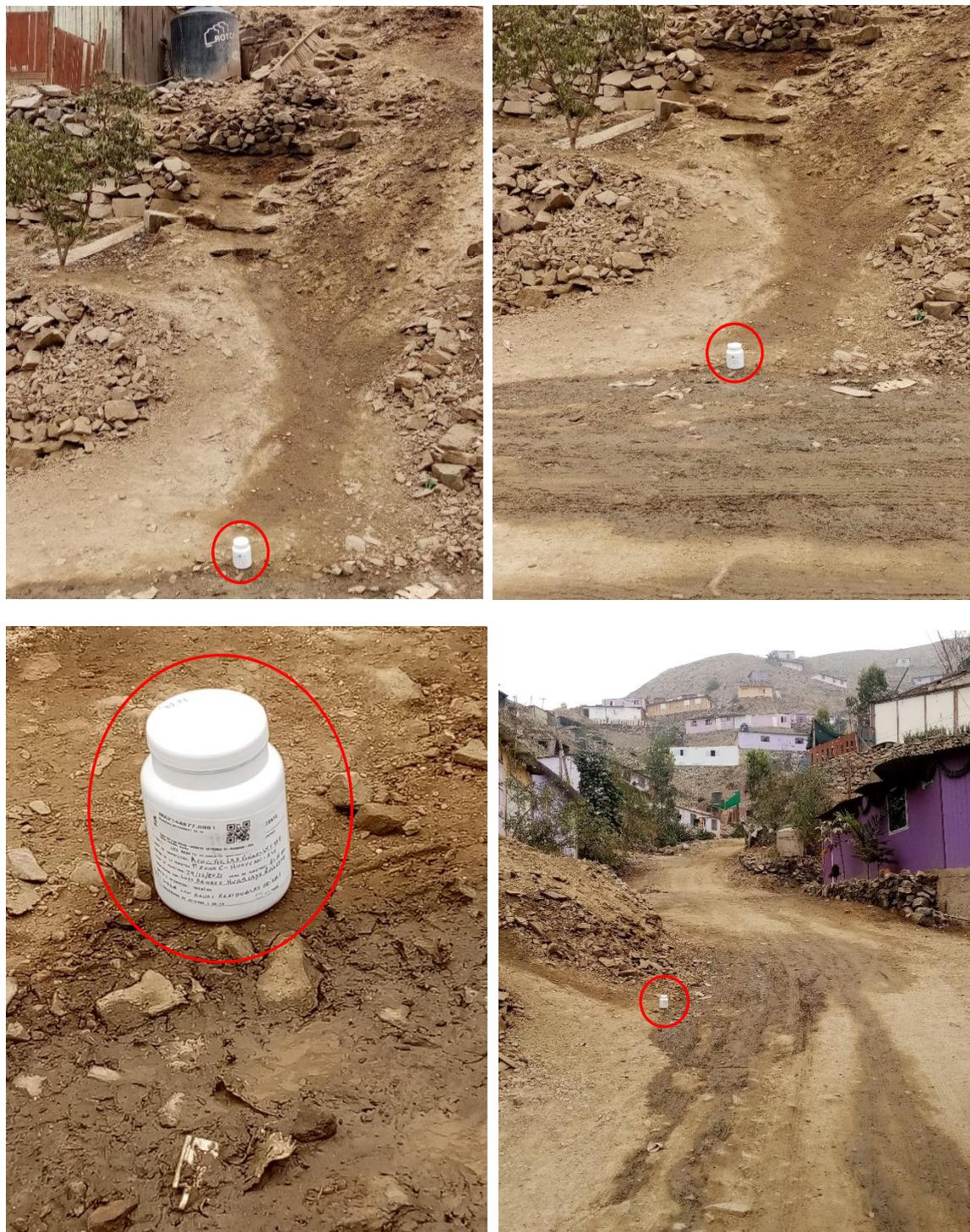
**Muestra N° 01.-** Suelo de vía pública principal de la Asociación de vivienda Las Viñas - UCV 47B, 1° zona C, Huaycán - Ate, contaminada con aguas residuales grises recolectado en frasco de muestreo (identificado con círculo rojo). Nótese la humedad permanente del suelo a lo largo de toda la vía frente a cada lote de vivienda. Fuente: Elaboración Propia 2021
