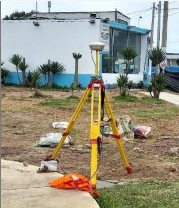
Asimismo, se ubicaron 5 puntos de apoyo para la georreferenciación y ajustes de la ortofoto generada a partir de las imágenes capturadas por el dron. Cada uno de ellos fue levantado con GPS tipo Rover por un lapso de 1 minuto.
