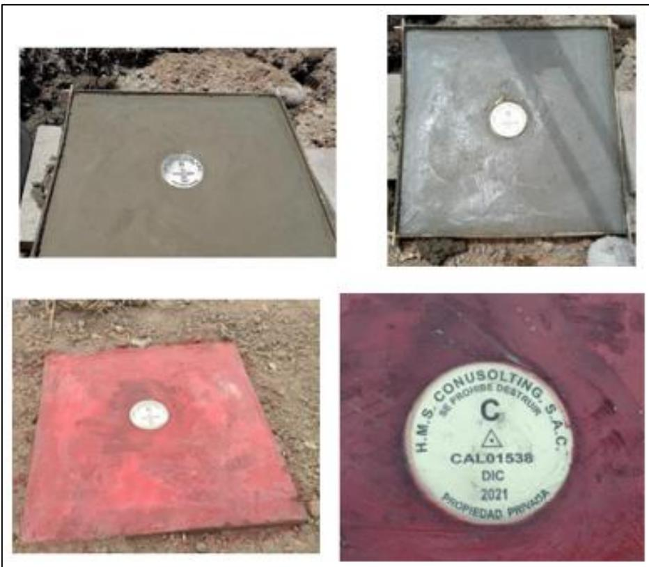
**4.4.1.2 Receptor GPS en modo RTK.** Se realizó la lectura con GPS Diferencial registrándose información por un lapso aproximado de 3 horas. La finalidad del establecimiento del control topográfico horizontal/vertical, es establecer 01 punto geodésico con coordenadas conocidas y de alta precisión georreferenciadas al marco de referencia peruano, la cual se permitirá iniciar el trabajo topográfico o establecer poligonales de apoyo secundarios, dentro del área de trabajo.
