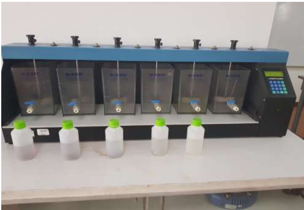
Preparación del Floculador Programable
