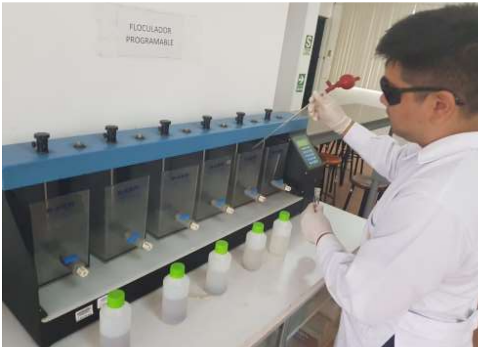
Acondicionamiento de muestras a flocular.
