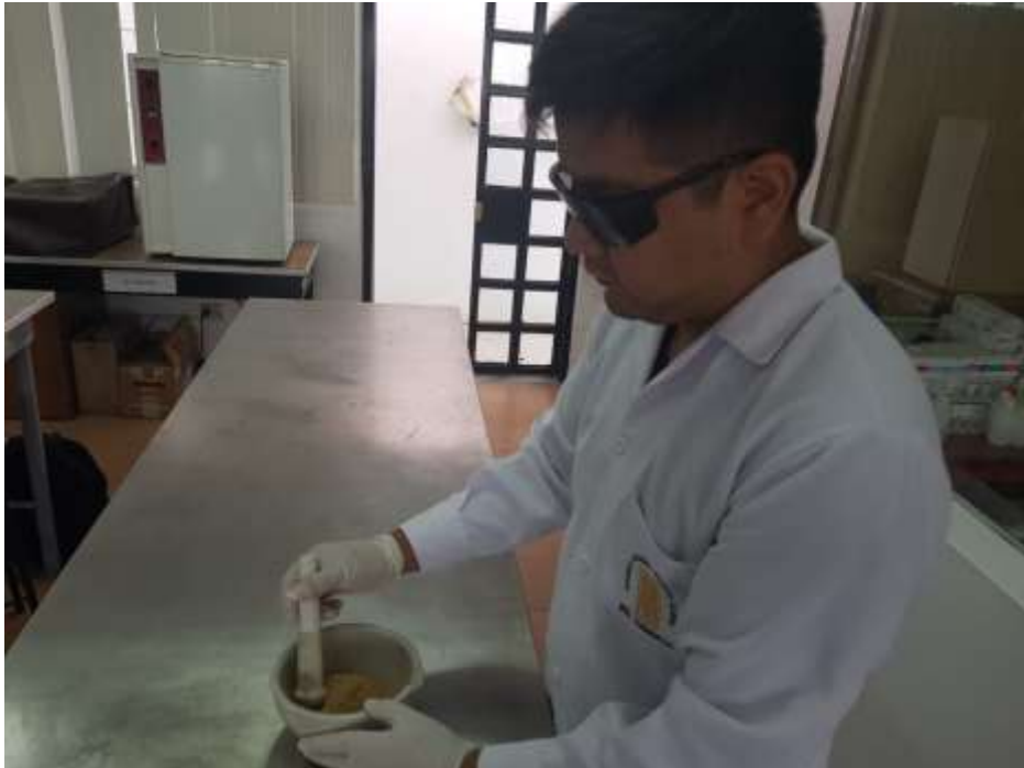
Trituración final del Biosorbente de Naranja
