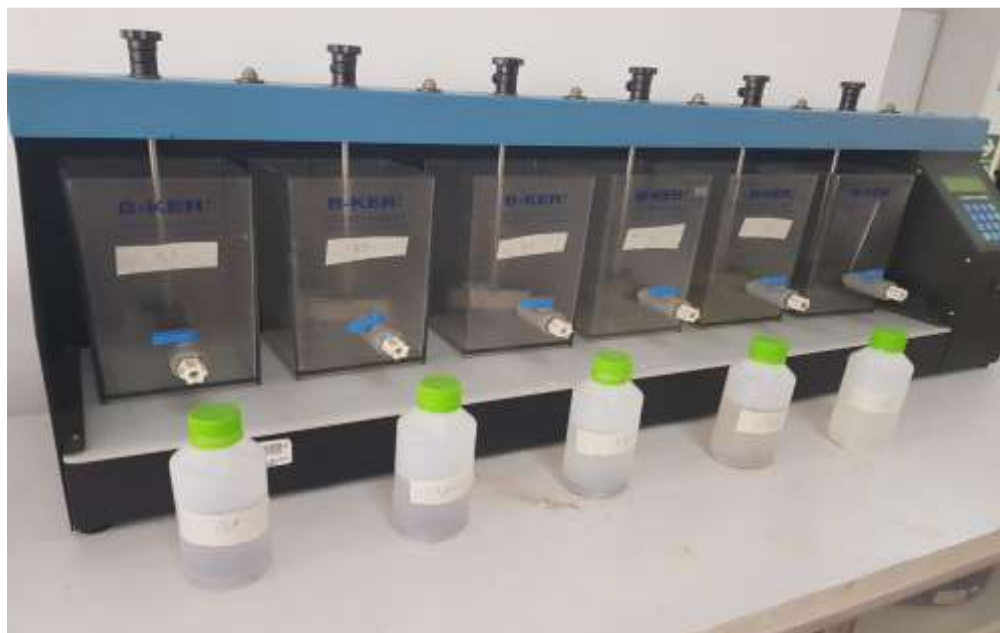
Acondicionamiento de muestras a flocular.
