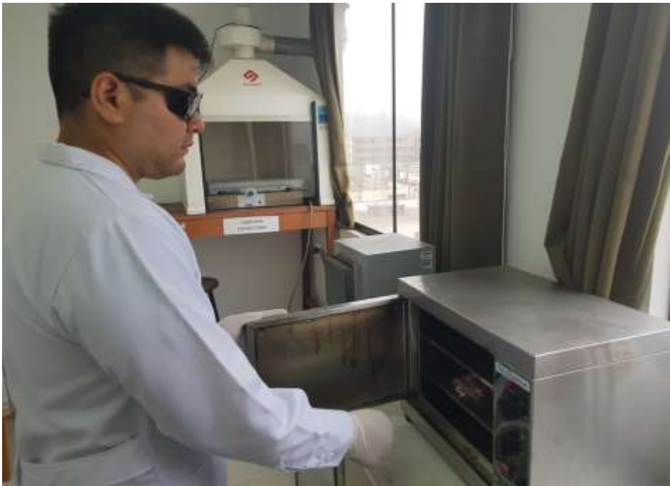
Secado inicial del Biosorbente de Naranja
