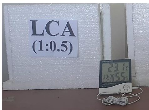
a) Termómetro digital marca VZN HTC-2 b) Termómetro digital marca Borosil. Nota. En la figura se muestran los termómetros que fueron utilizados durante la experimentación.
