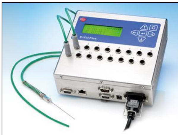
Figura 12. Equipo Ellab para toma de datos de Temperatura (Termocuplas)
