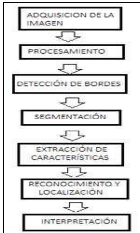
Figura 1. Fases del proceso de funcionamiento de Visión artificial al determinar una imagen
