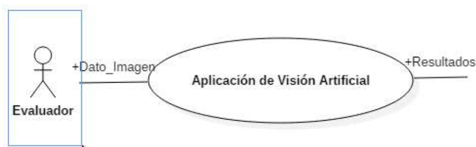
Figura 8. Diagrama de Caso de uso de la Aplicación de Visión Artificial
