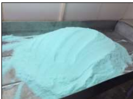
Figura 13: Sulfato ferroso heptahidratado
