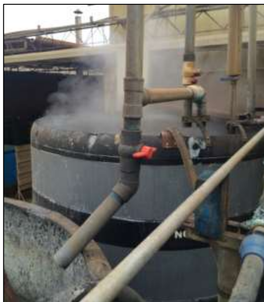
Figura 03: Digestión de virutas de acero con H 2 SO 4 cc
