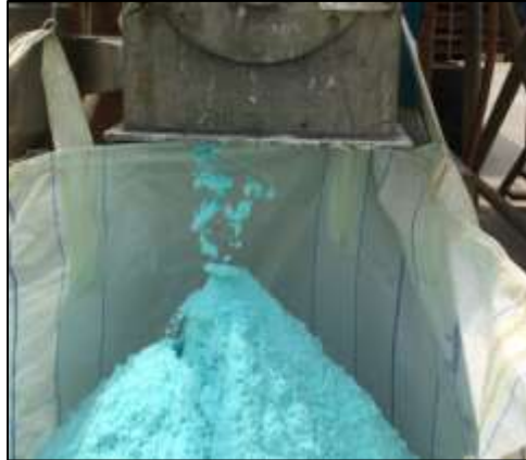
Figura 07: Obtención de cristales de sulfato ferroso
