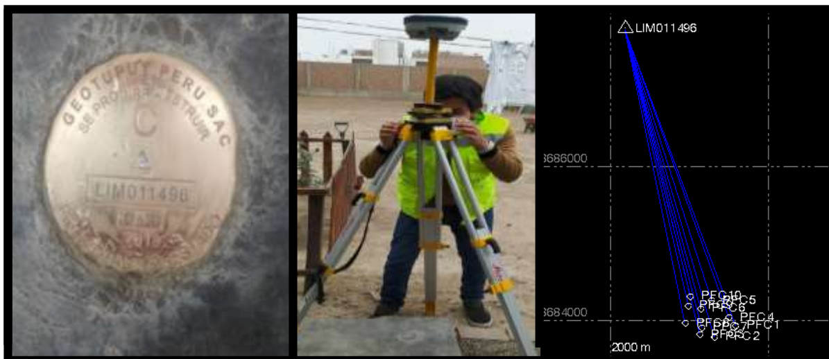
Figura 3: En la primera imagen se observa el punto geodésico de orden “C” denominado “LIM011496” el cual fue monumentado por la empresa GEOTUPUY S.A.C. y certificado por el Instituto Geográfico Nacional (2018). Dicho punto geodésico es considerado como punto base para la obtención de las coordenadas absolutas de los 10 puntos fotocontrol, los cuales han sido identificados sobre elementos en tierra para la posterior georreferenciación de la ortofoto obtenida por el procesamiento del levantamiento fotogramétrico del Drone (ver Plano N° 26). En la segunda imagen se muestra el receptor GNSS SOKKIA GRX1, el cual fue empleado para el cálculo de coordenadas de los puntos fotocontrol mediante el método “estático rápido” (ocupación en simultaneo de dos receptores GNSS con tiempos de observación de pocos minutos, cuya precisión es de 1 - 2 cm). Posterior al levantamiento geodésico en campo se realizaron los procesamientos en gabinete con el software “Trimble Business Center” (tercera imagen), cuyos resultados se muestran en la tabla 2 y 3 (anexos), basándose en los datos técnicos mostrados en la Tabla 1 (anexos). Fuente: Elaboración Propia
