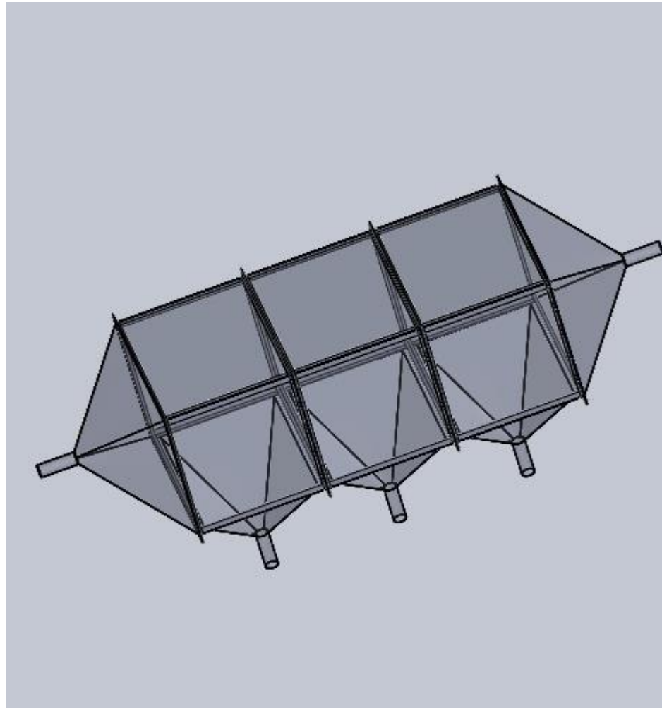
Figura 40. Vista en perfil sin recubrir (esqueleto) de la Cámara de Sedimentación por Gravedad.
