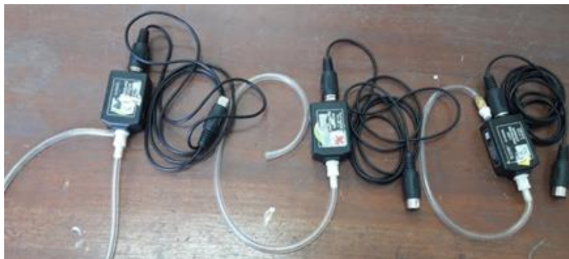
Figura 47. Sensores de baja presión en unidades de kPa marca PASCO.
