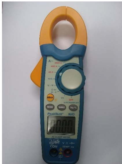
Figura 49. Amperímetro de mordaza (Pico de Loro) marca PeakTech.
