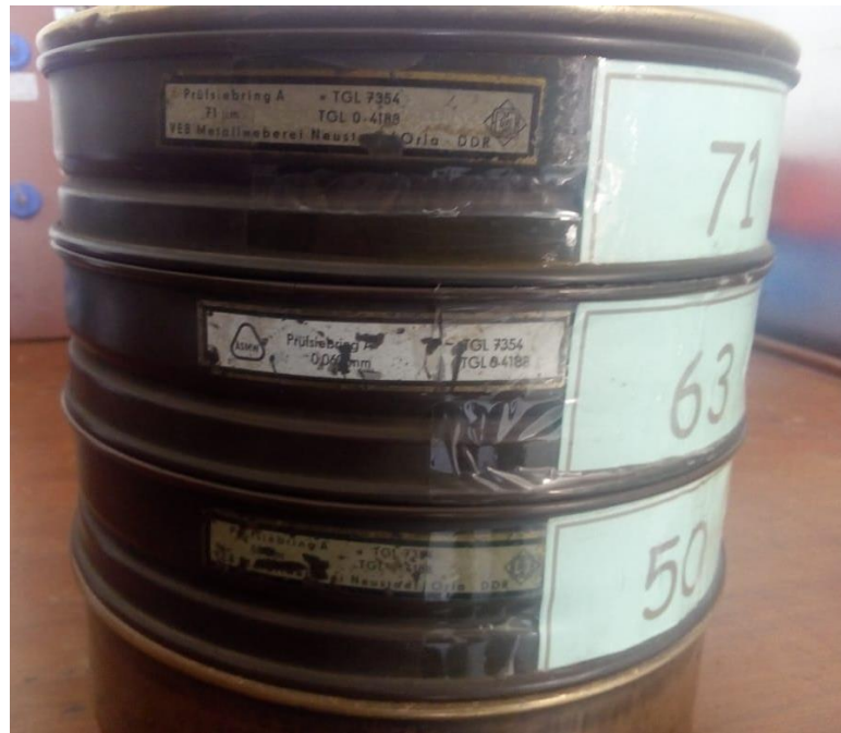
Figura 26. Tamices de 50 \mu\text{m} , 63 \mu\text{m} y 71 \mu\text{m} para el chuño.
