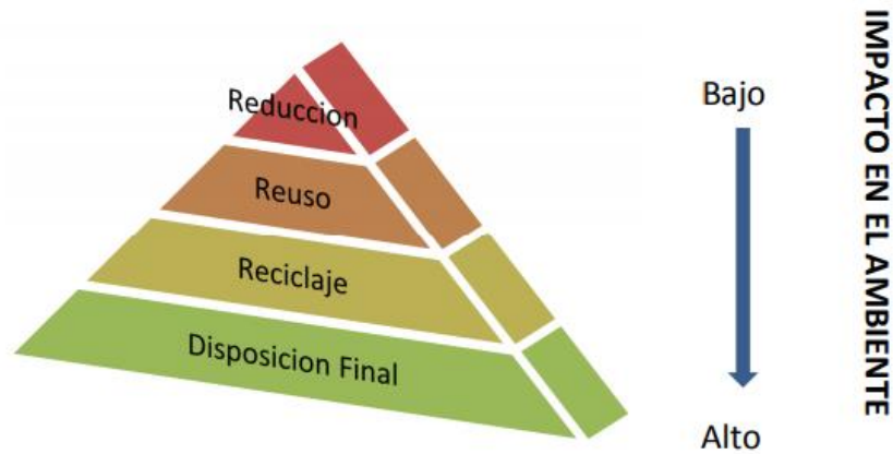
Figura 5. Método Jerarquizado para el manejo de RCD. Fuente: Yuang & Shen (2011).
