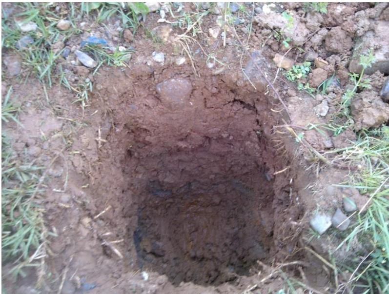
**Foto N° 06.** Vista de Estación 01 - Calicata **C-01** para toma de datos de mecánica de suelos (Contenido de humedad y densidad)
