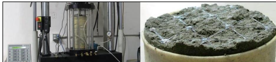
Grafico 10 “Ensayo de módulo de resiliencia que confirma el aumento de la rigidez gracias a la inclusión de la geomalla triaxial de Tensar dentro de una capa de agregado”. (Fuente: Tensar, 2015)
