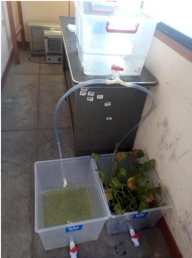
Figura 10: Sistema de tratamiento con macrófitas flotantes
