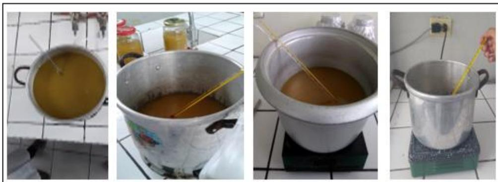
**Figura 28. Tratamiento térmico de mostos hidrolizados a 85°C por 10 minutos para inactivar la enzima Celulasa. (Etapa 1)**
