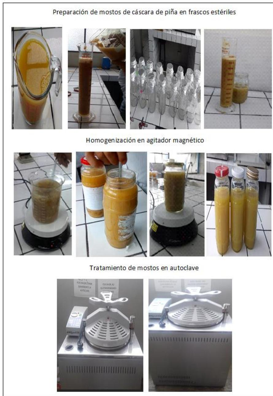
**Figura 25. Acondicionamiento de mostos en frascos esterilizados para su tratamiento térmico en autoclave (Etapa 1).**
