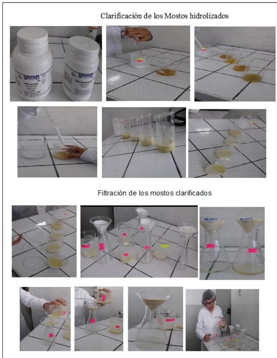
**Figura 30. Preparación de las muestras para analizar azúcares reductores (Método Eynon-Lane). (Etapa 1).**
