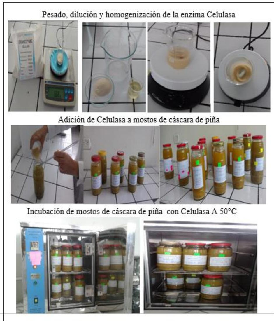
**Figura 26. Hidrólisis enzimática de las cáscaras de piña con Celulasa al 2%.
