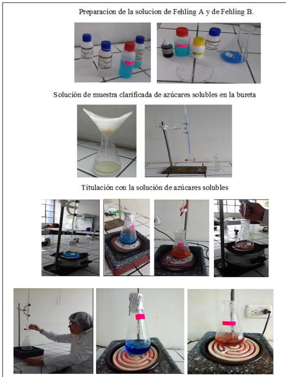
**Figura 31. Prueba cuantitativa de determinación de azúcares reductores método volumétrico de Eynon-Lane (Etapa 1).**
