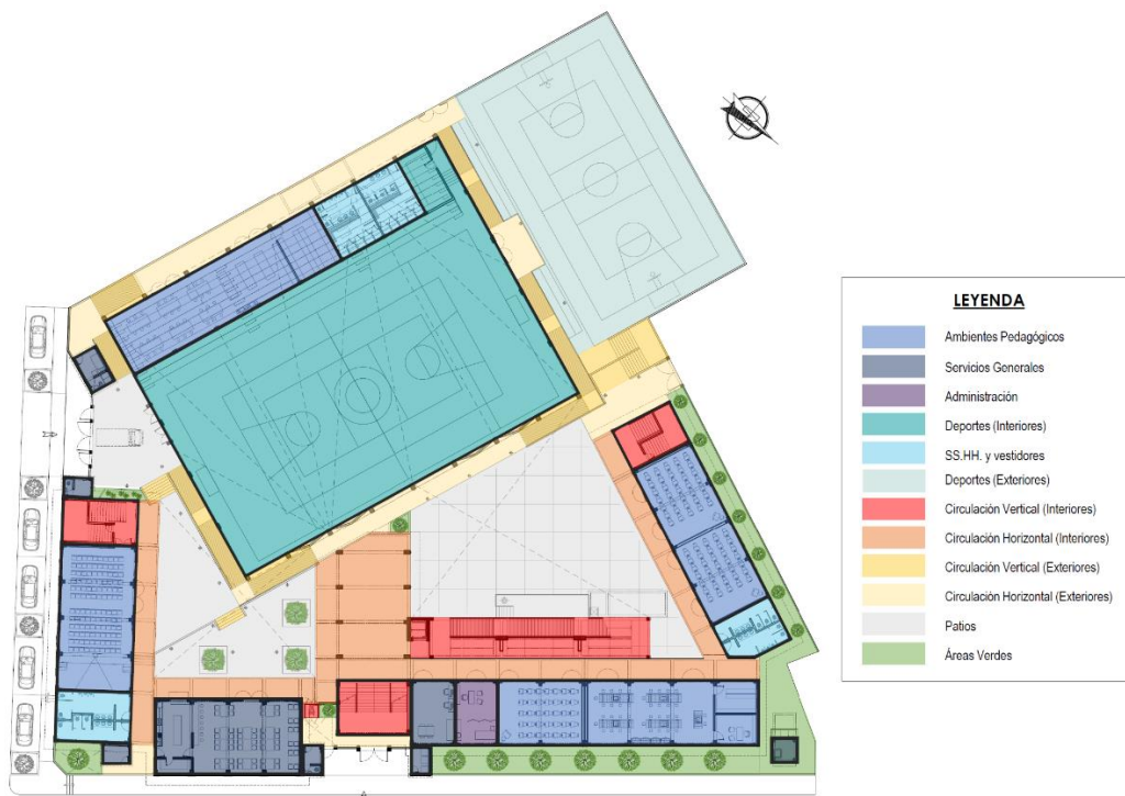
Figura 64. Zonificación del Primer Nivel Fuente: Elaboración propia
