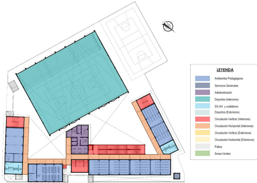
Figura 65. Zonificación del Segundo Nivel Fuente: Elaboración propia
