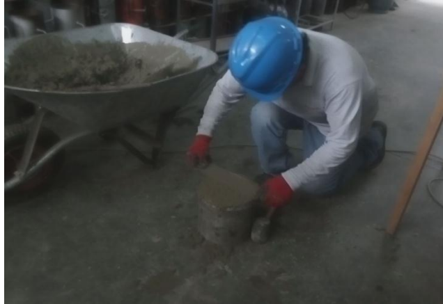
Fotografía N° 24: Alisado de la superficie superior del recipiente.
