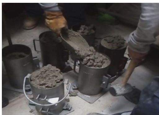
Fotografía N° 31: Colocación de mezcla en el molde y golpeado ligeramente con martillo para eliminar los vacíos.
