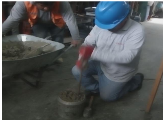
Fotografía N° 23: Apisonado del concreto fresco en el recipiente.
