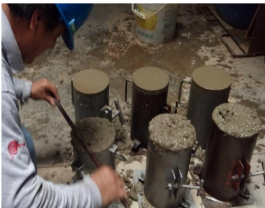
Fotografía N° 32: Enrasado de las probetas cilíndricas
