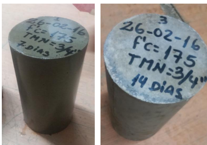
Fotografía N° 33: Especímenes cilíndricos correctamente identificados.
