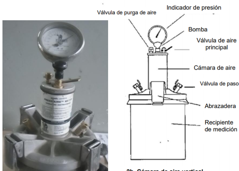
Fotografía N° 26: Medidor de aire Tipo B
