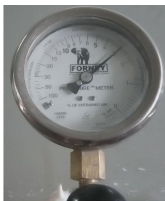
Fotografía N° 29: Lectura del porcentaje de aire en el manómetro.
