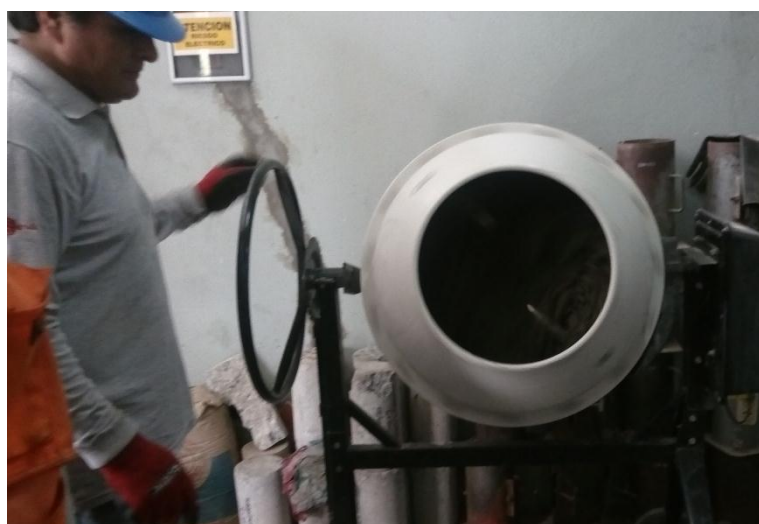
Fotografía N° 18: Mezclado del material durante 3 minutos aproximadamente.
