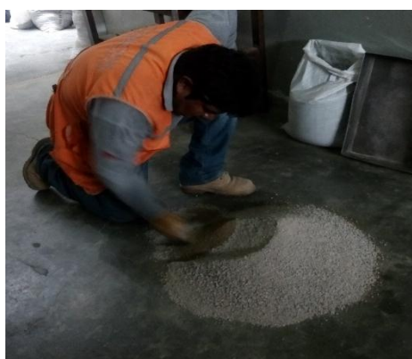
Fotografía N° 12: Mezcla del agregado fino natural con el agregado fino reciclado.
