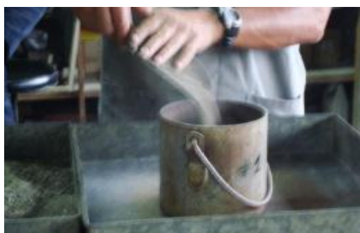
Fotografía N° 11: Colocación del Agregado fino mezclado en el recipiente para calcular el Peso Unitario Suelto
