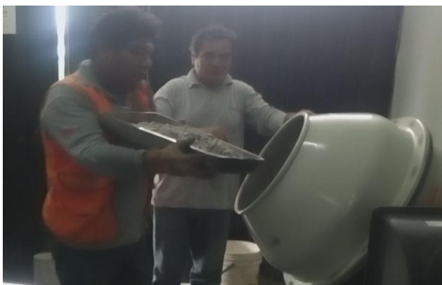
Fotografía N° 17: Colocación del Agregado grueso en la mezcladora mecánica
