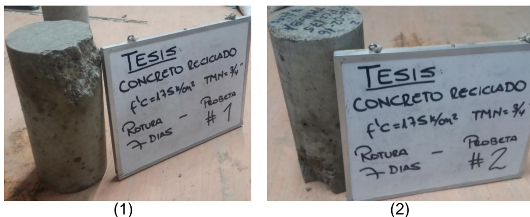
Fotografía N° 38: Tipos de fracturas en las probetas N° 1 y N° 2
