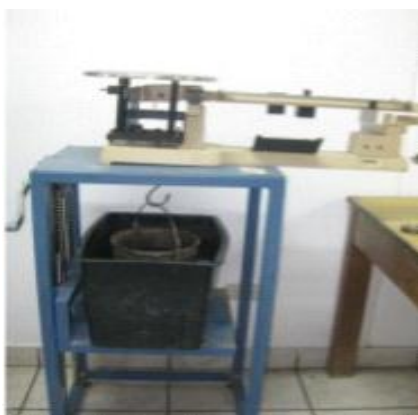
Fotografía N° 9: Material saturado superficialmente seco en la cesta de alambre.
