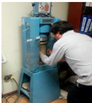
Fotografía N° 36: Colocación de la probeta en la máquina de ensayo a la compresión
