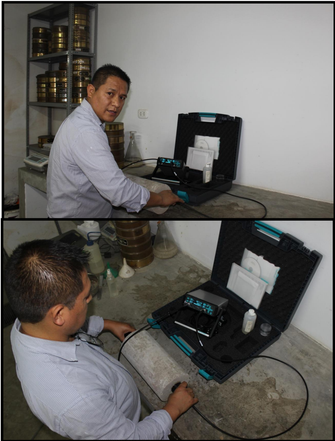
Figura 54: Ensayo de velocidad del ultrasonido a los testigos de concreto.
