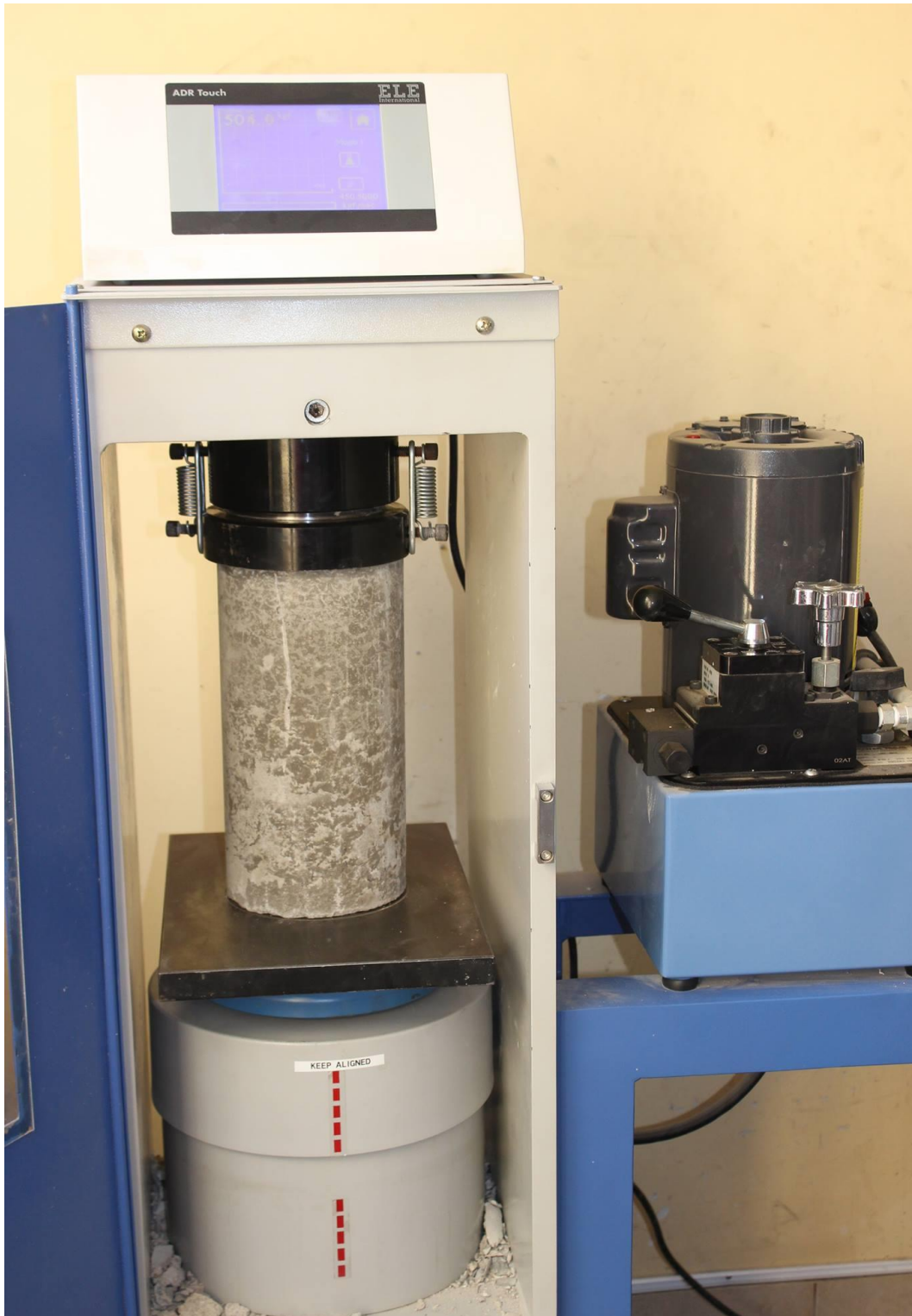
Figura 56: Ensayo de resistencia en compresión de testigos de concreto
