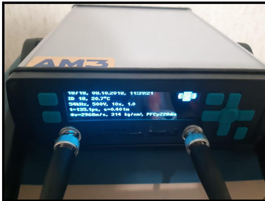
Figura 43: Equipo medidor de velocidad del ultrasonido
