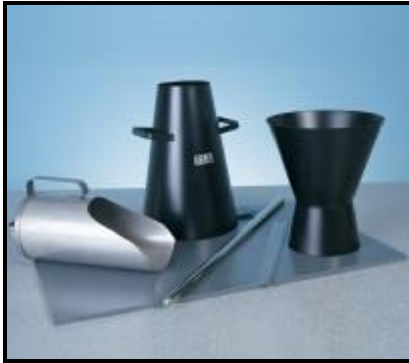
Figura 14: Conjunto Cono Abrahams para ensayo de asentamiento.
