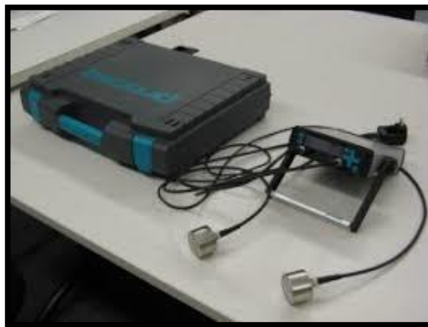
Figura 20: Equipo medidor de velocidad del ultrasonido.
