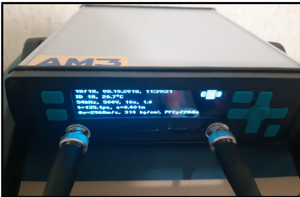
Figura 25: Resistencia en compresión del concreto de las estructuras de concreto, mostrado en la pantalla del equipo medidor de la velocidad del ultrasonido
