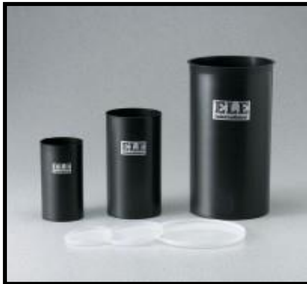
Figura 17: Moldes para testigos de concreto
