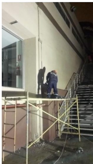
Fotografía N°51. Extracción de muestra en columna del 1° nivel – Eurodiomas. Fotografía N°52. Rotulación de prueba en losa M-11 del 1° nivel - Eurodiomas.
