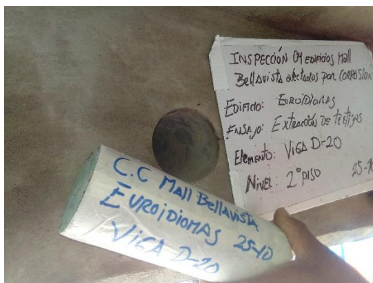
Fotografía N°61. Testigo diamantino de viga D-20 del 2° Piso - Euroidiomas.
