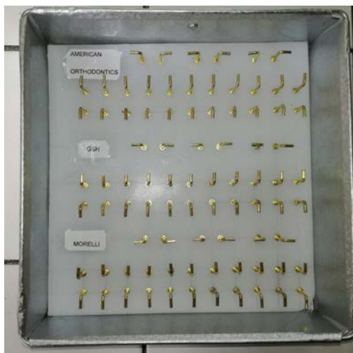
Fig.10. Caja metálica con pines metálicos correctamente dividido en tres grupos para los tres grupos de ligas.
