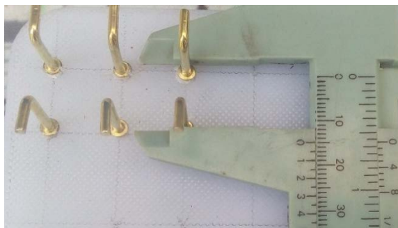
Fig.03. Separación de 14.4 mm de distancia entre cada pin metálico.
