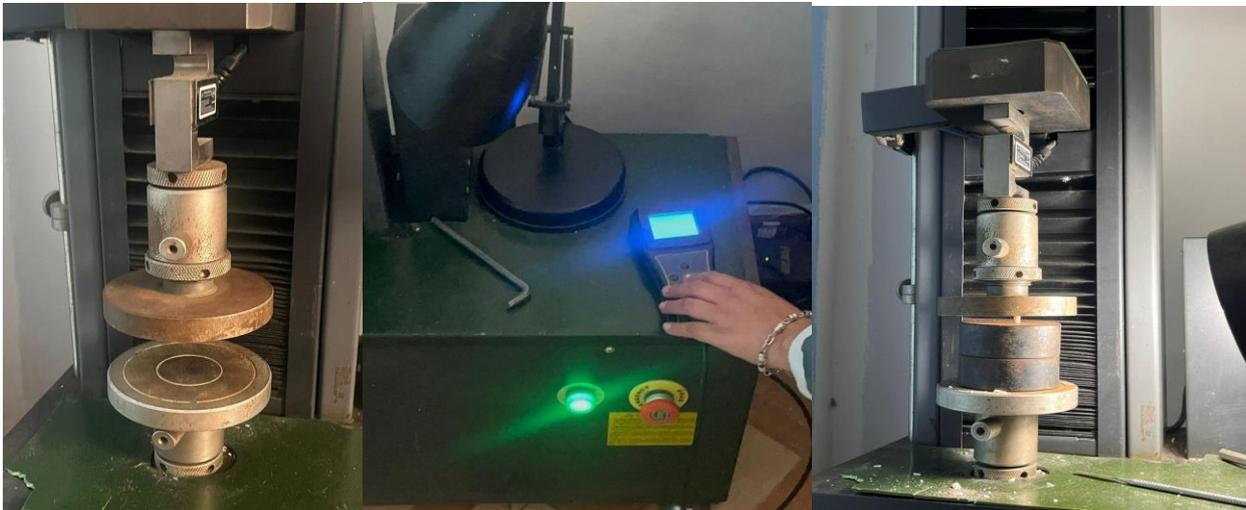
Imagen n°8. Prueba de resistencia a la compresión de las muestras
