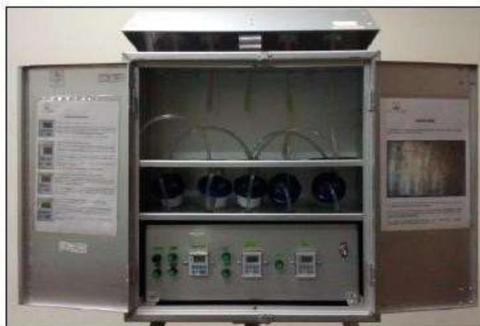
**Nota:** Captador de gases del aire sean dióxido de azufre, dióxido de nitrógeno, monóxido de carbono, benceno, sulfuro de hidrogeno y ozono
