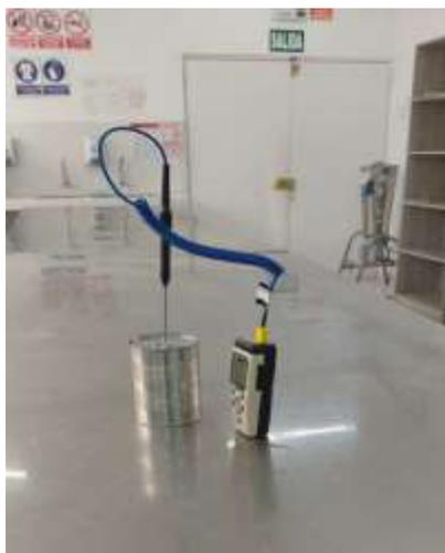
*Nota.* La punta del vástago de la termocupla se introdujo al centro geométrico de la lata y el cable de conexión se introdujo por una espita lateral de la autoclave, y se realizó la lectura externamente con el equipo digital, cuyos resultados se evalúan en la curva de penetración de calor.
