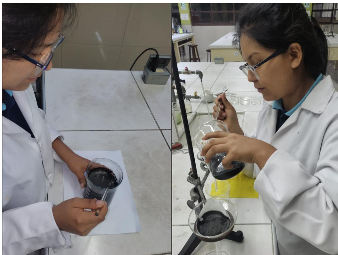
Lavado del carbón activado
