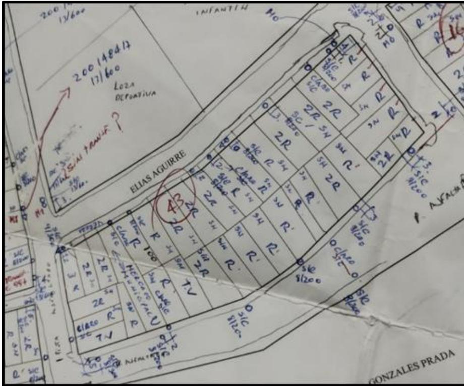
*Nota.* Se identificó la variedad de postes, sus códigos, alturas, líneas de red, distancia de veredas y ubicación de postes medidas con el instrumento odómetro.
