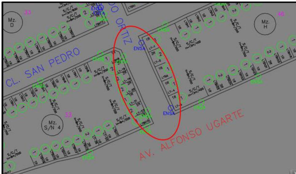
*Nota.* Se digitalizó los postes de baja tensión (Bt), media tensión (Mt) y alta tensión (At) (Transformadores).
