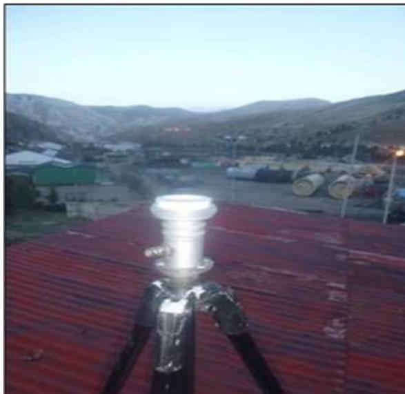
Una vez colocado el filtro se cierra el soporte enroscándola. Se coloca a presión el cabezal sobre la estructura ya instalada (trípode y cabezal) de manera que quede correctamente encajado. Luego se instala el vaso porta humedad (Figura 12).
