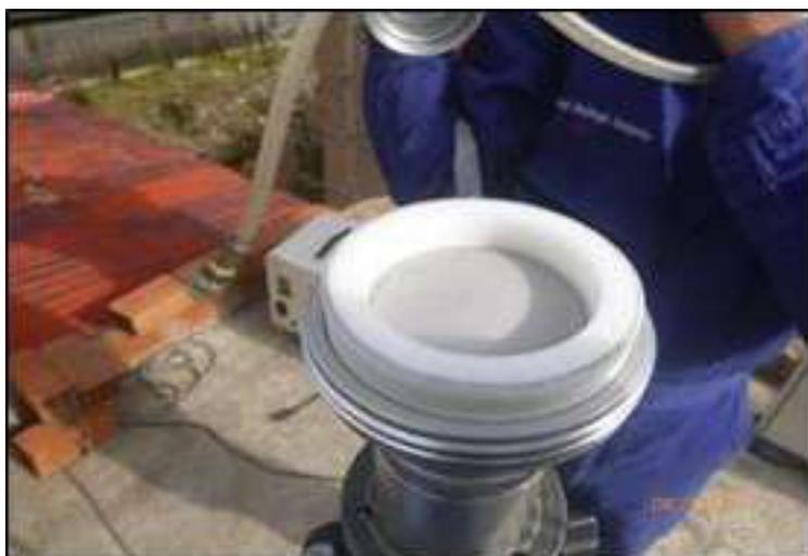
Se instala el trípode, a una altura no menor de 1.5 metros. Se instala el soporte para los
