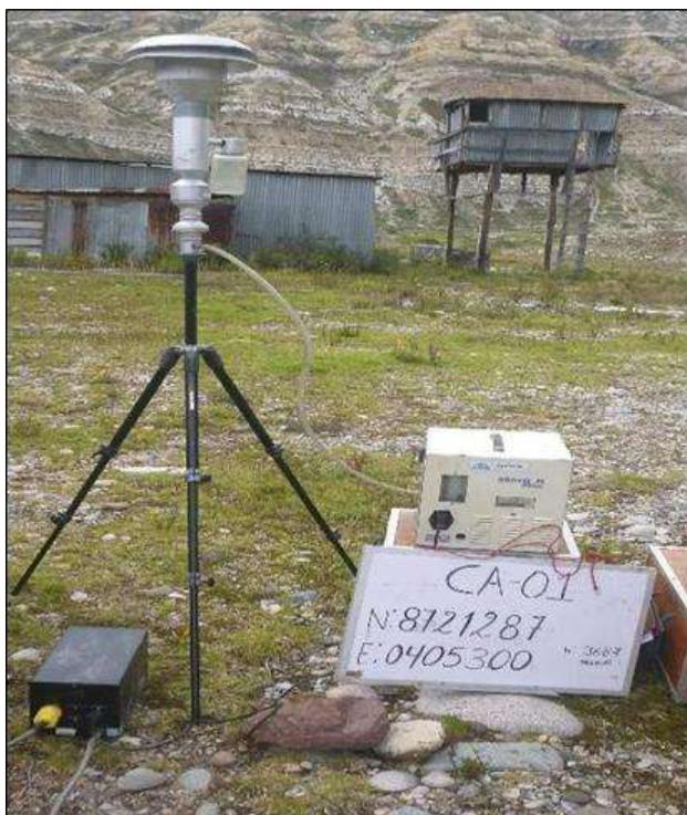
Para instalación del filtro, se utilizó guantes de látex o nitrilo, procediendo a colocar el filtro en forma horizontal con la cara rugosa hacia arriba (Figura 10).
