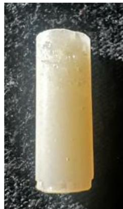
6. Medición de las muestras según lo indicado por la norma ISO 3597-3 para poder ser enviadas a laboratorio en donde se realizará el termociclado y la prueba de resistencia compresiva.
