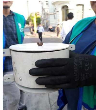
Fotografía 08: Portatubo pasivo que se instaló en los semáforos de las avenidas
