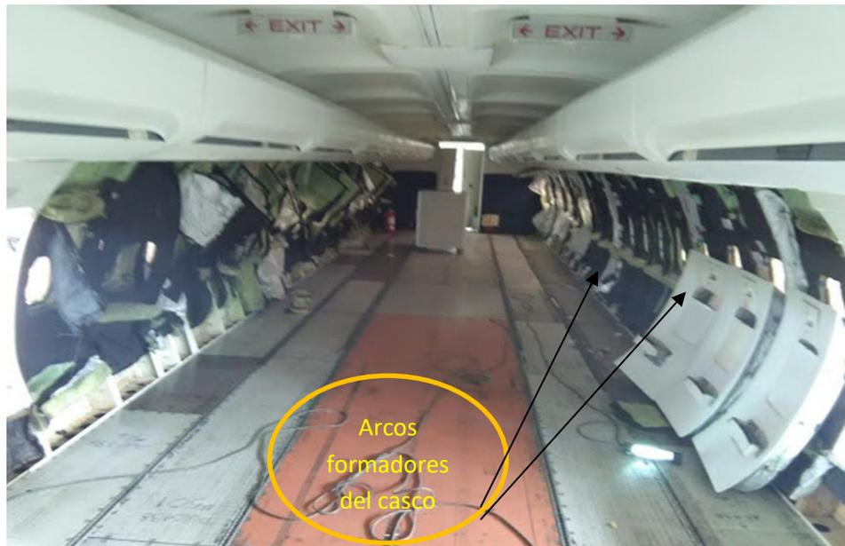
*Nota.* Imagen de los arcos y largueros descubiertos para la toma de las placas radiográficas de un Boeing 73. Elaboración propia.
