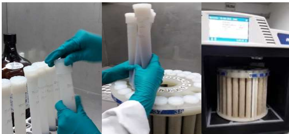
Figura N° 12: Posicionamiento de liner e ingreso al microondas
