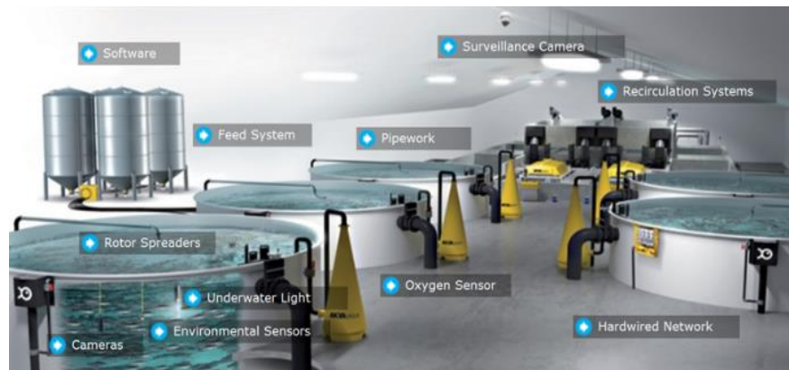
Figura 24. Sistema RAS que incluye Software, sistema de alimentación, esparcidores de rotor, luz subacuática, sensores ambientales, cámaras, tuberías, sensor de oxígeno, Cámara de vigilancia, sistemas de recirculación, red cableada. Fuente: TeamGemini, 2019.
