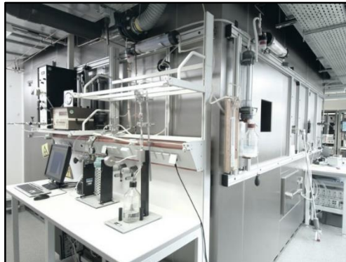
Figura 24. Cámara de radón del laboratorio de referencia BfS
