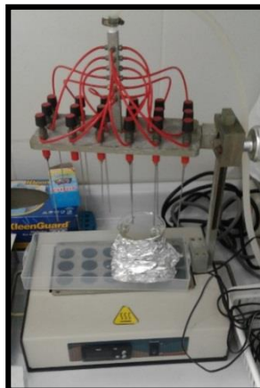
Figura 16: Evaporador de nitrógeno con termostato.
