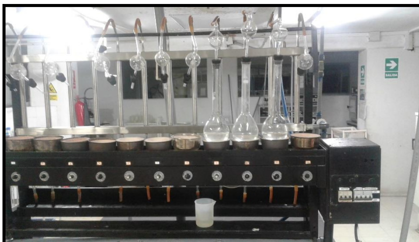
Figura 30: Equipo de destilación de 12 balones para el análisis de TVN.
