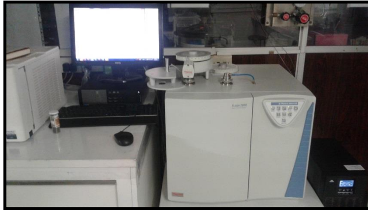
Figura 28: Equipo Dumas Thermo Scientific Flash 2000 N/Protein para la determinación de proteínas
