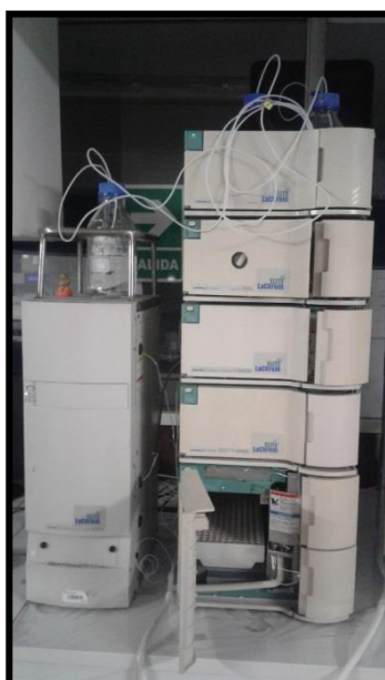
Figura 31: Equipo de cromatografía líquida de alta eficiencia Elite Lacrom con cuatro canales acoplado a fluorescencia.
