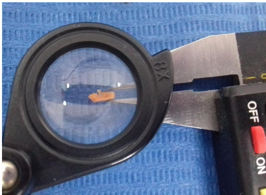
FOTOGRAFIA n°14: Medición de la silicona con el vernier electrónico.
