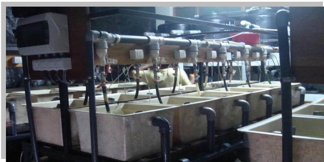
Figura 8. Circuito de recirculación de agua clara (CAC).
