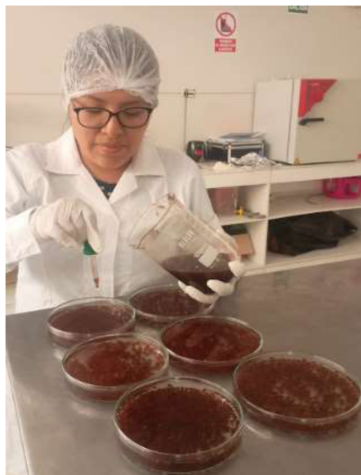
Goteo de la solución de alginato de sodio + harina de sangre de pollo en la solución de cloruro de calcio.
