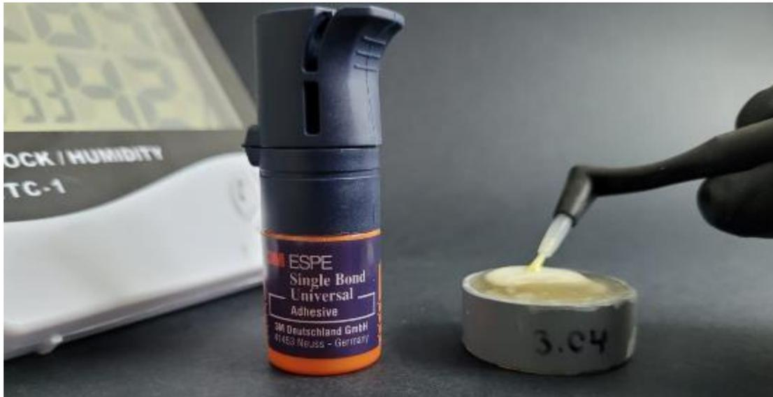
Aplicación de Adhesivo Universal en especimen con trazos longitudinales a 1.3 gr/f y control de temperatura y humedad.
