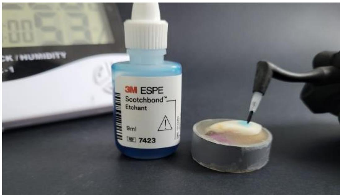
Aplicación de ácido fosfórico al 37% en especimen con trazos longitudinales a 1.3 gr/f y control de temperatura y humedad.
