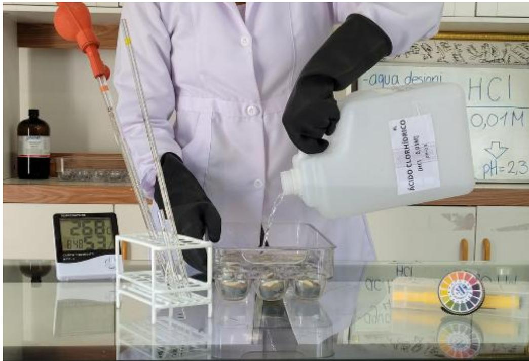
Ciclaje erosivo controlado con pH metro de papel, con control de temperatura y humedad dentro de los rangos determinados
