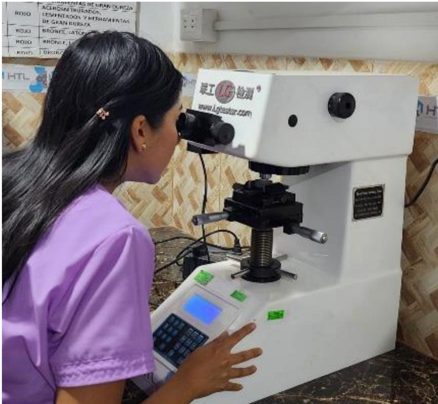
Observación del centrado de los especímenes en el microdurómetro
