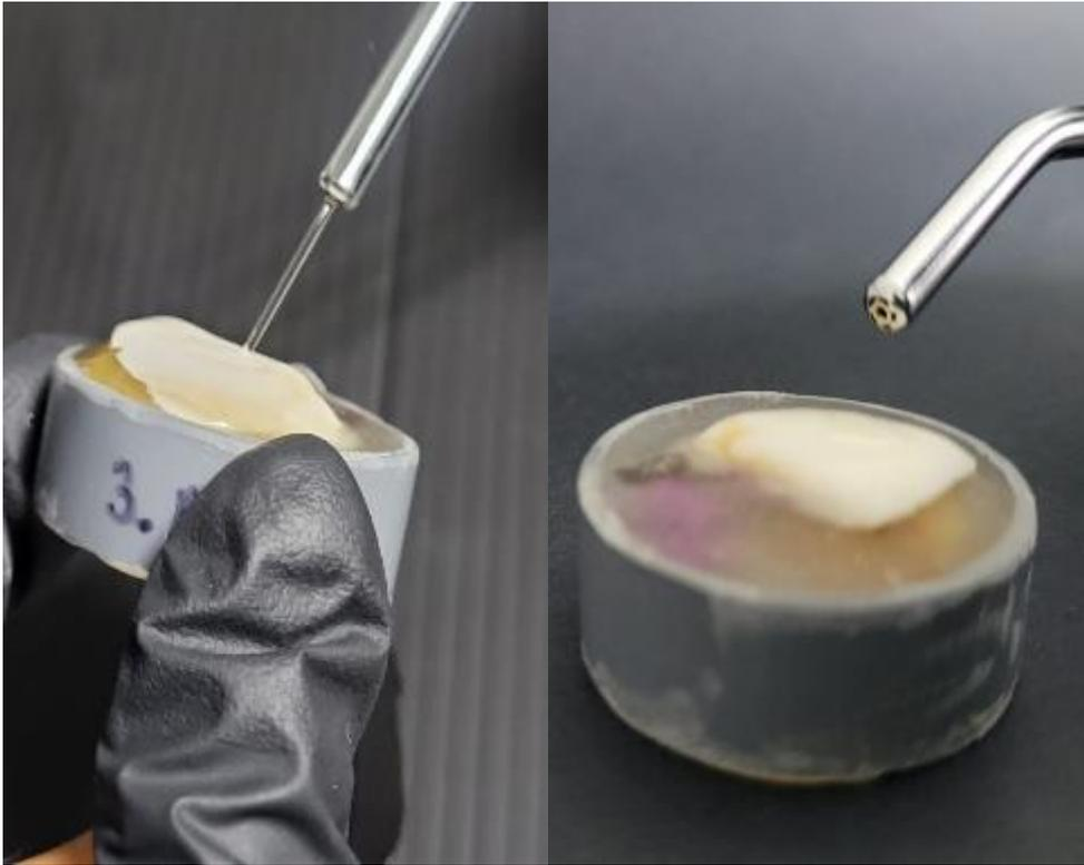
Lavado perpendicular y secado diagonal de los especímenes por 10 y 3 segundos respectivamente
