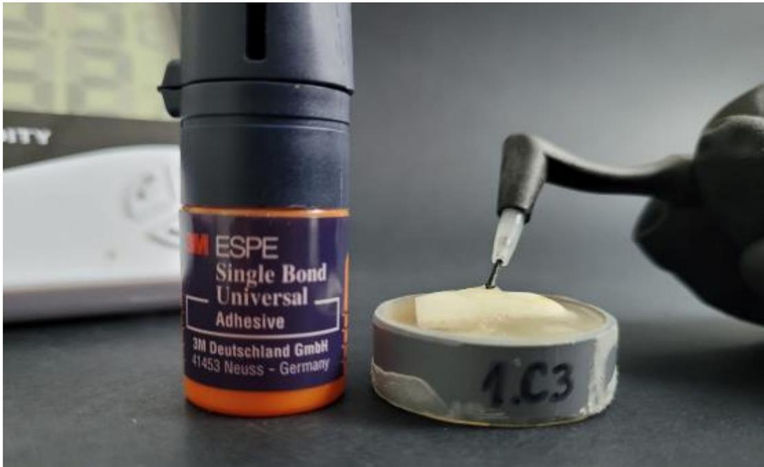
Aplicación de Adhesivo Universal en especimen sobre superficie grabada con trazos longitudinales a 1.3 gr/f y control de temperatura y humedad.
