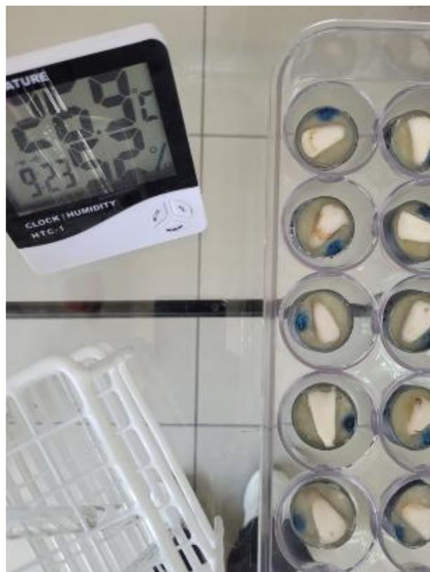
Termómetro e hidrómetro con el depósito individualizado de cada espécimen con número y color identificador de grupo
