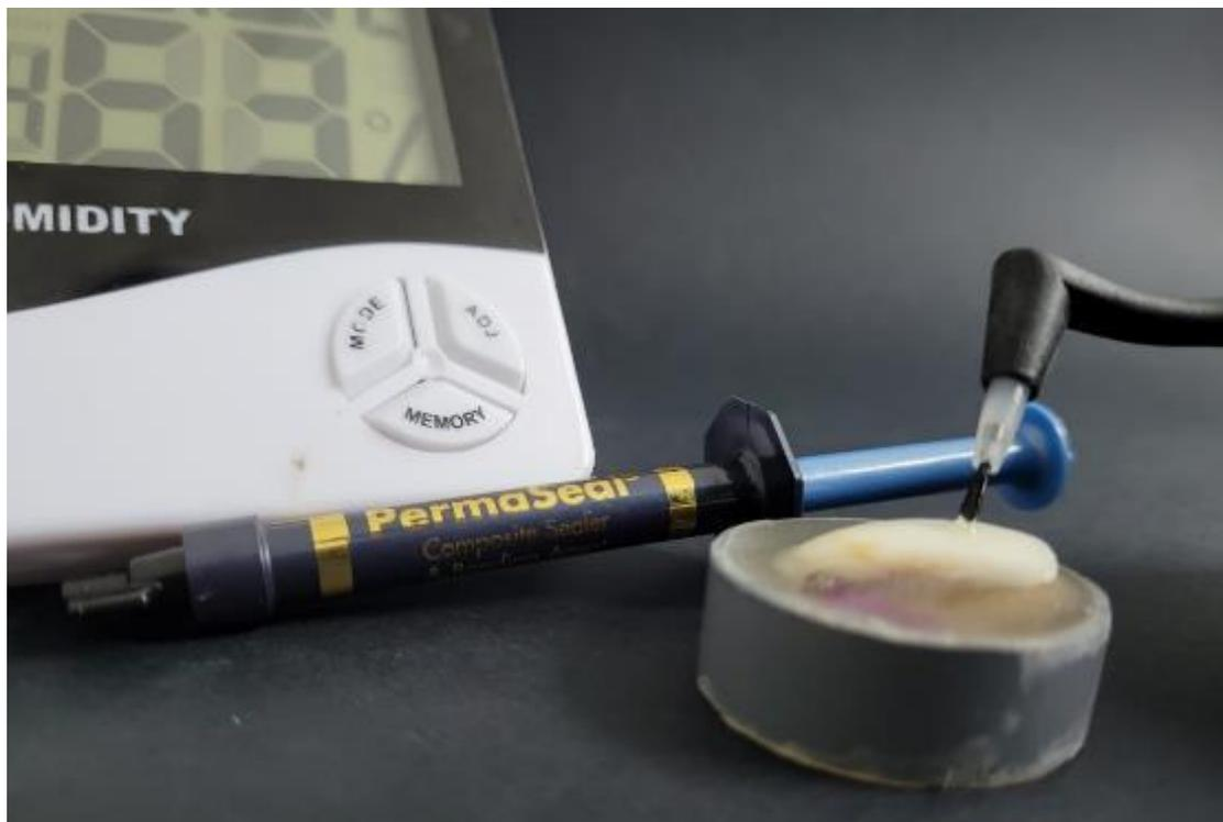
Aplicación de PermaSeal sobre superficie grabada con trazos longitudinales a 1.3 gr/f y control de temperatura y humedad.
